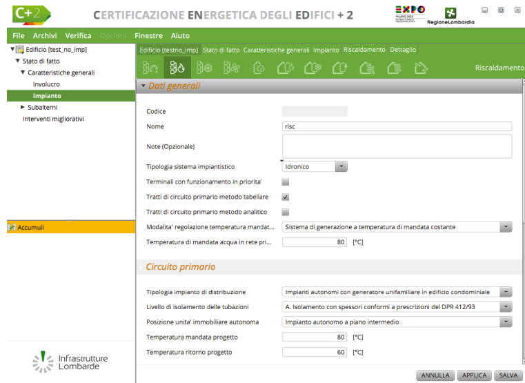
FIG 3 - sistema impiantistico di riscaldamento
